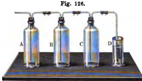
Füllen von Flaschen mit trockenem Chlorgase.
